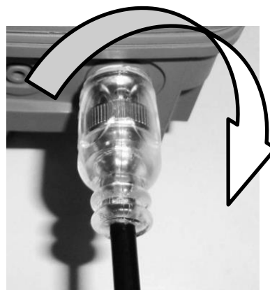
Tourner la fiche ¼ de tour pour fermer la connexion
